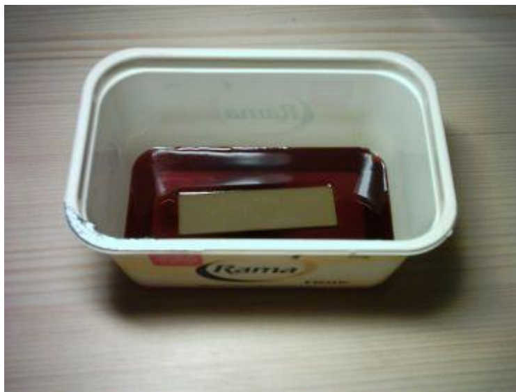
Leptanie DPS v chloride železitom
